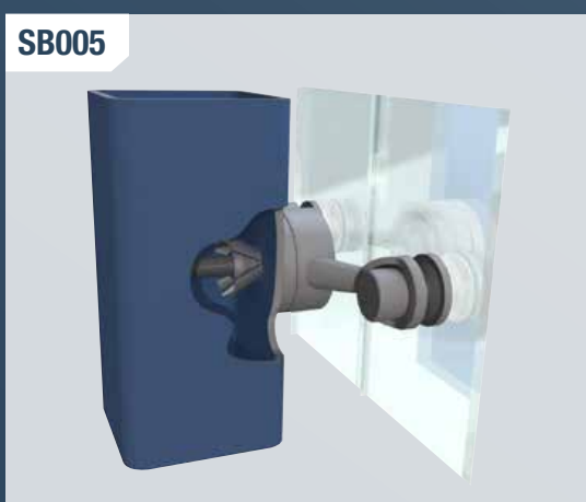
Hollo-Bolt de fixation de l'attache de la façade vitrée aux profilés creux.
